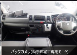
バックカメラ(助手席前に専用モニタ)
